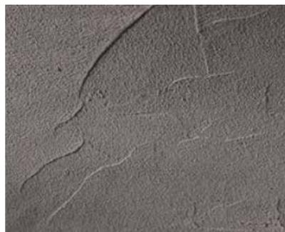
Le revêtement effet béton à base d'eau possède une fine teneur en quartz, et s'applique avec une spatule manuelle.
