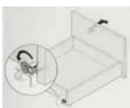
Regolazione dell'inclinazione tramite la guida
