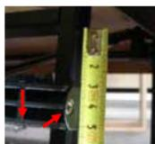
Lorsque le plateau de table se referme trop facilement, il est possible d'utiliser un tournevis cruciforme pour abaisser les deux étriers à gauche et à droite d'environ 1 cm pour atteindre 4 cm.
