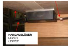
I tavoli vengono regolati esattamente prima della consegna. C'è anche la possibilità di regolarli manualmente con una brugola da 8 mm in corrispondenza della guaina. Nello svitare la vite viene aumentata la forza di trazione. Nell'avvitare viene diminuita.
