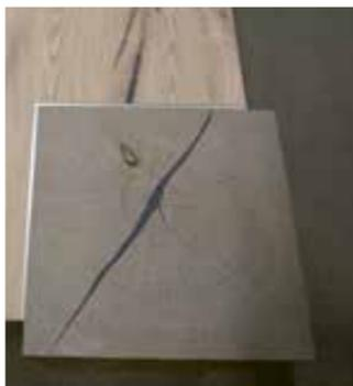
Les couleurs et structures différentes, petites fissures, légers défauts, excroissances et branches sont des propriétés naturelles de la matière première. Les nœuds plus larges sont comblés par un matériau de remplissage, selon le modèle. Ces propriétés propres au bois transforment chaque meuble en pièce unique. Les veines du bois des façades et des panneaux des tables à rallonges ne sont pas continues.
