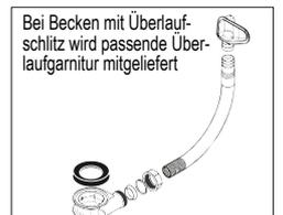
Bei Becken mit Überlaufschlitz wird passende Überlaufgarnitur mitgeliefert
