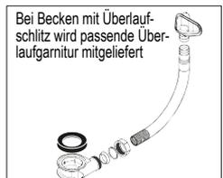
Bei Becken mit Überlaufschlitz wird passende Überlaufgarnitur mitgeliefert
