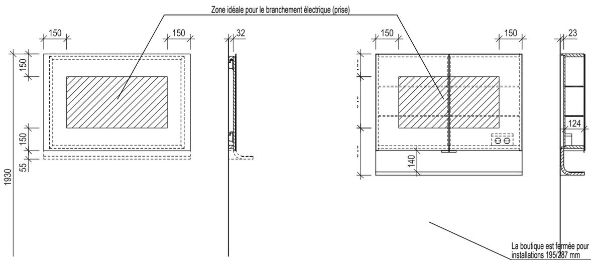
Armoires à glace avec tablette - Hauteur de montage bord supérieur 200 cm
